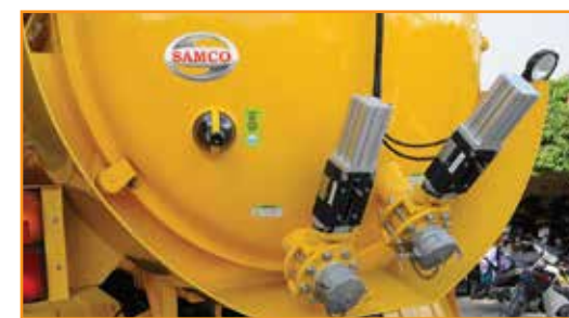
Van hút và van xả đóng mở bằng điện-khí nén Suction & exhaust valve controlled by electropneumatic system
